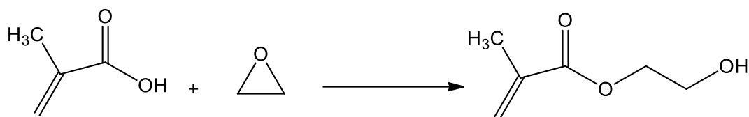
شکل ۲- سنتز HEMA با متاکریلیک اسید و اتیلن اکساید
